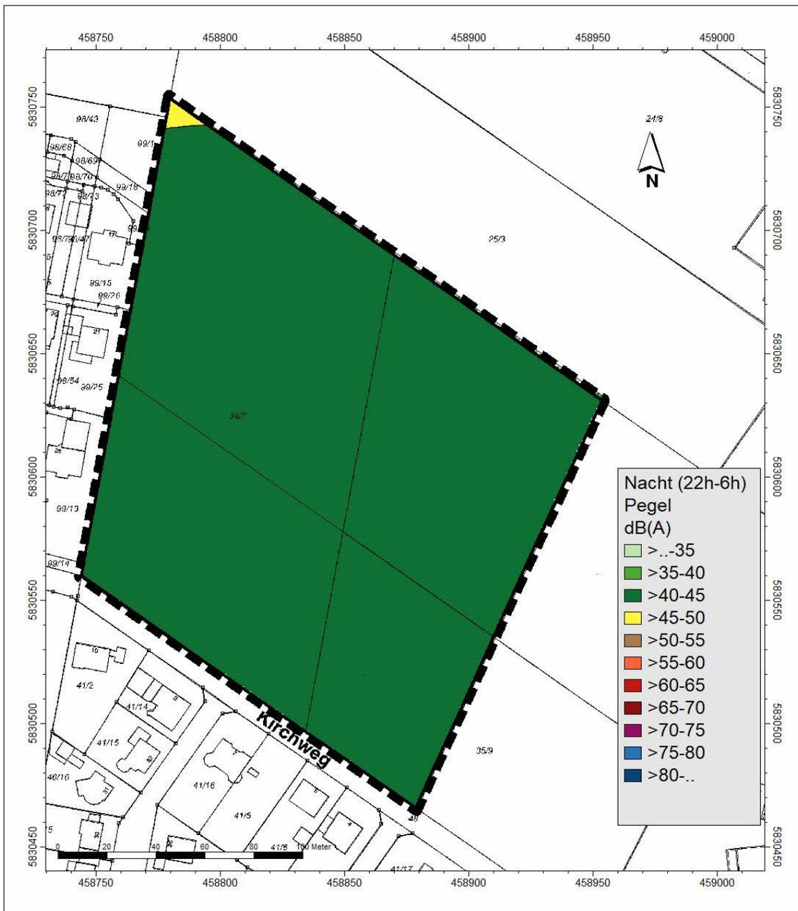
Abbildung 19: Rasterberechnung der Beurteilungspegel nachts, relative Höhe 4,80 m für das Prognosejahr 2034.
