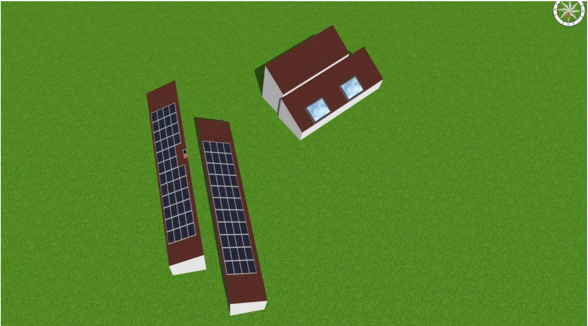
Zwei Ziegeldächer auf dem Südflügel des Rathauses mit einer Neigung von  $25^\circ$  und einer Ausrichtung 1x Ost und 1 x West
