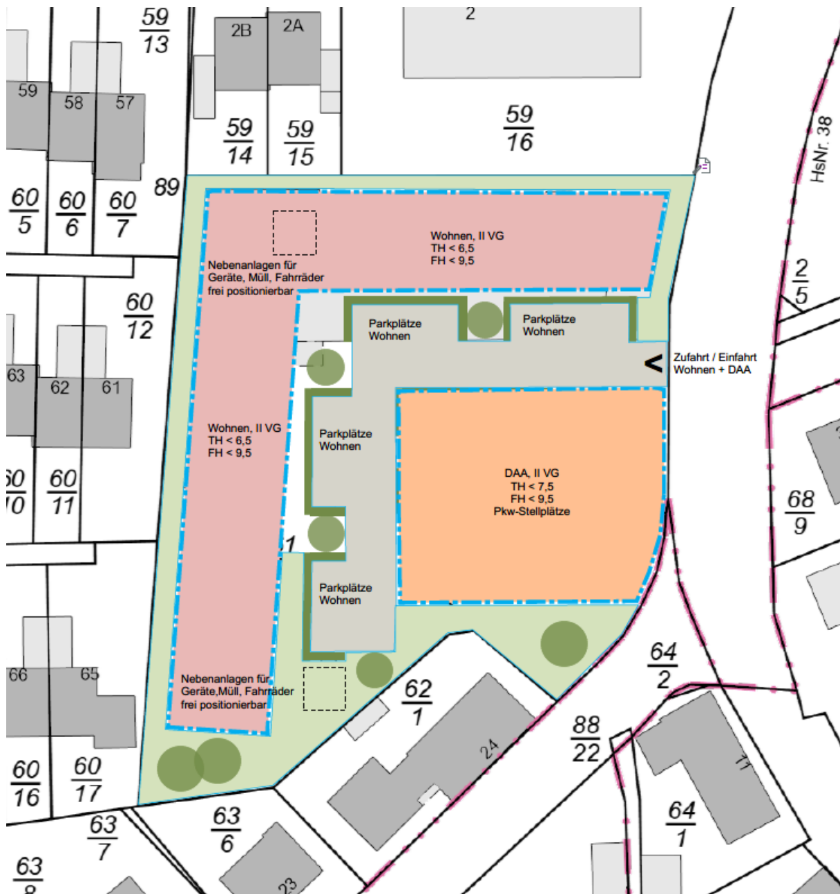
Abb. 2: Schematische Planzeichnung als Konzept des zu veräußernden Grundstückes mit eingetragenen Baufenstern und Zonierung der Nutzungen (Kartengrundlage Stadt Diepholz)
