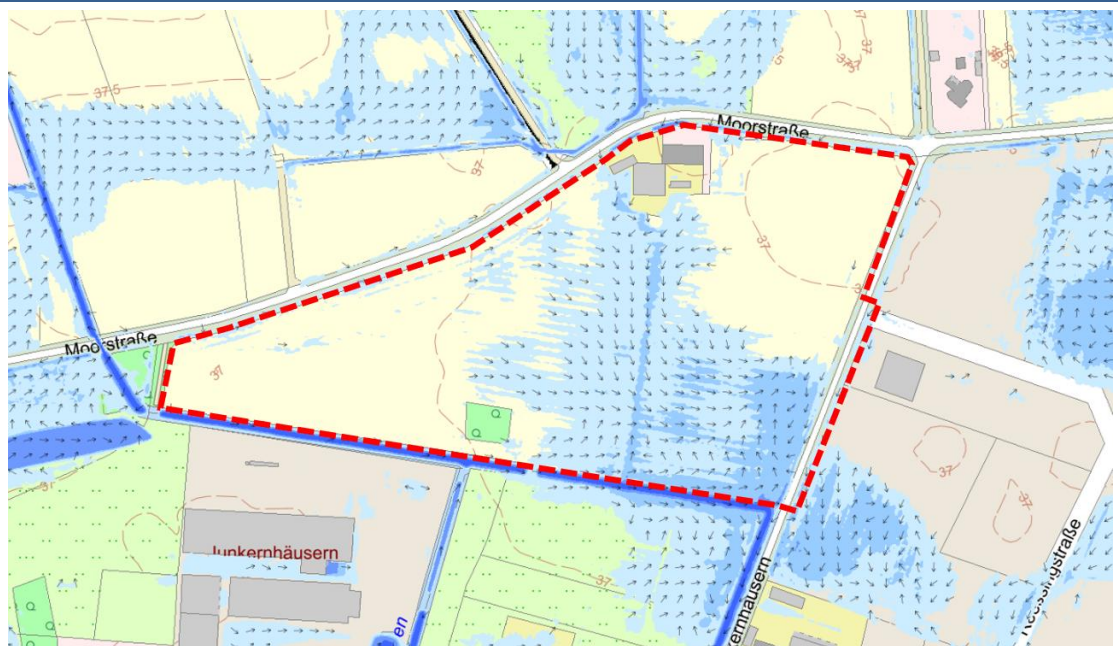
Abb. 15 Risikokarte Starkregen: Überflutungstiefen und Fließrichtung Extremfall
