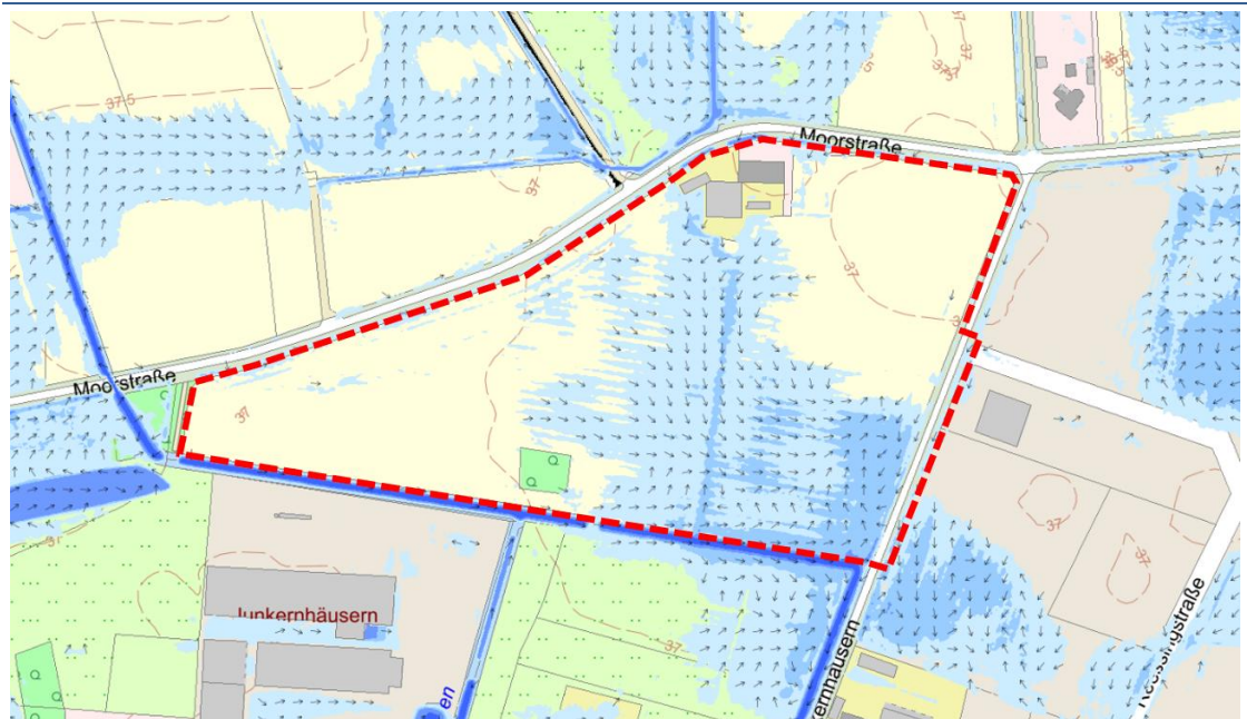
Abb. 18 Risikokarte Starkregen: Überflutungstiefen und Fließrichtung Extremfall
